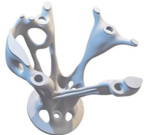
Fig. 1: Optimierte Struktur mit Berücksichtigung von Schraubenverbindungen
