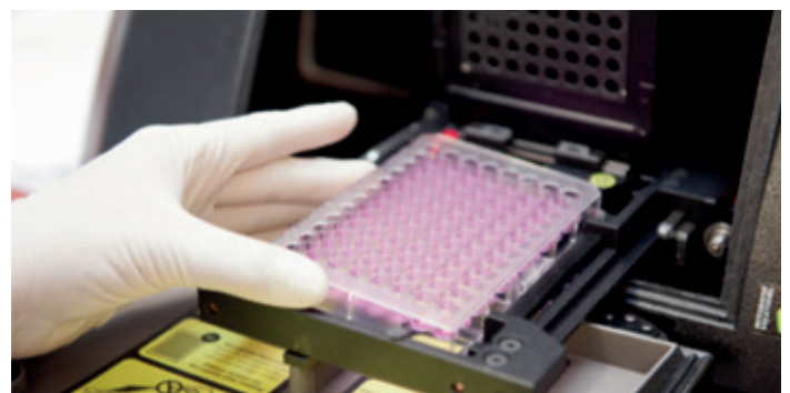
Toxizitätstest im Multiwell-Reader: Eine Platte erlaubt das Testen von ca. 12 verschiedenen Medikamenten
